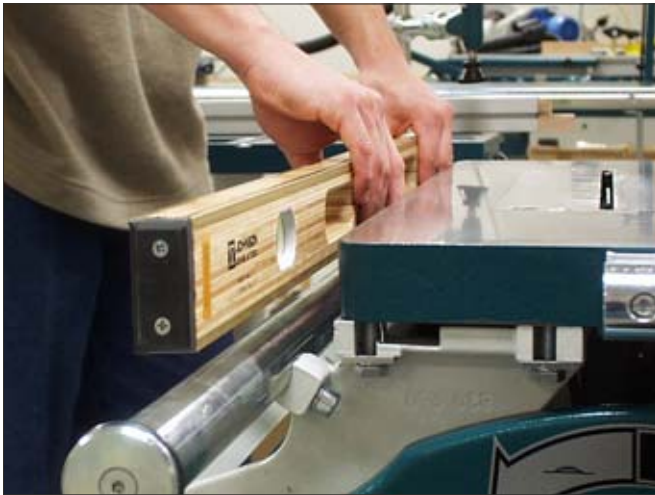
S-A Checking level of round roll bar.
